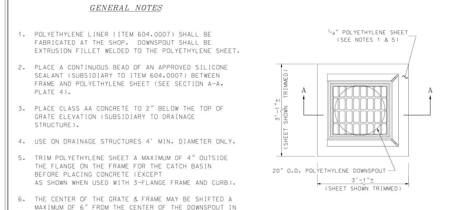
UNDERDRAIN FLUSHING BASIN
