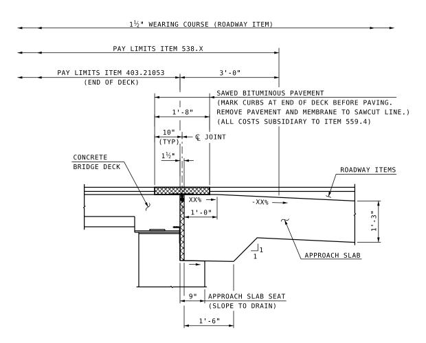
APPROACH SLAB - ASPHALTIC PLUG EXP. JOINT
